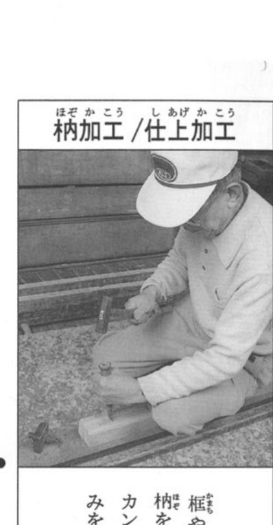
枠や棧、組子を組み合わせるための凹凸の枘を、部材に合わせて加工する。カンナで表面をなめらかに仕上げ、部材の厚みをそろえたり、装飾加工をする。
